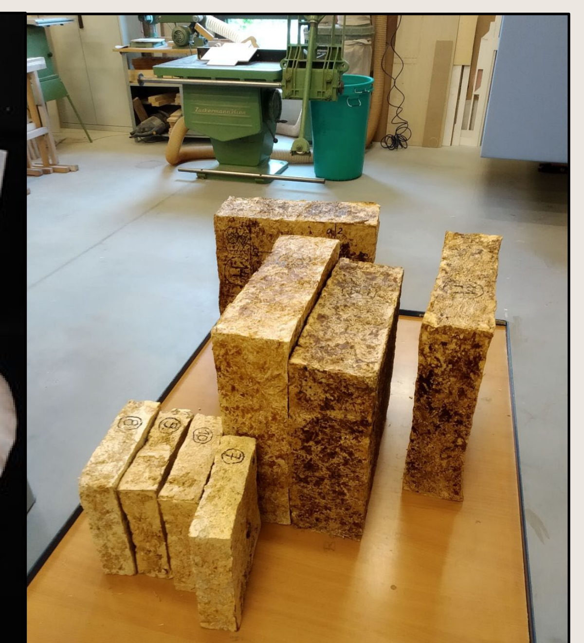
Abb. 4: Entformte und getrocknete Mycomaterialien
