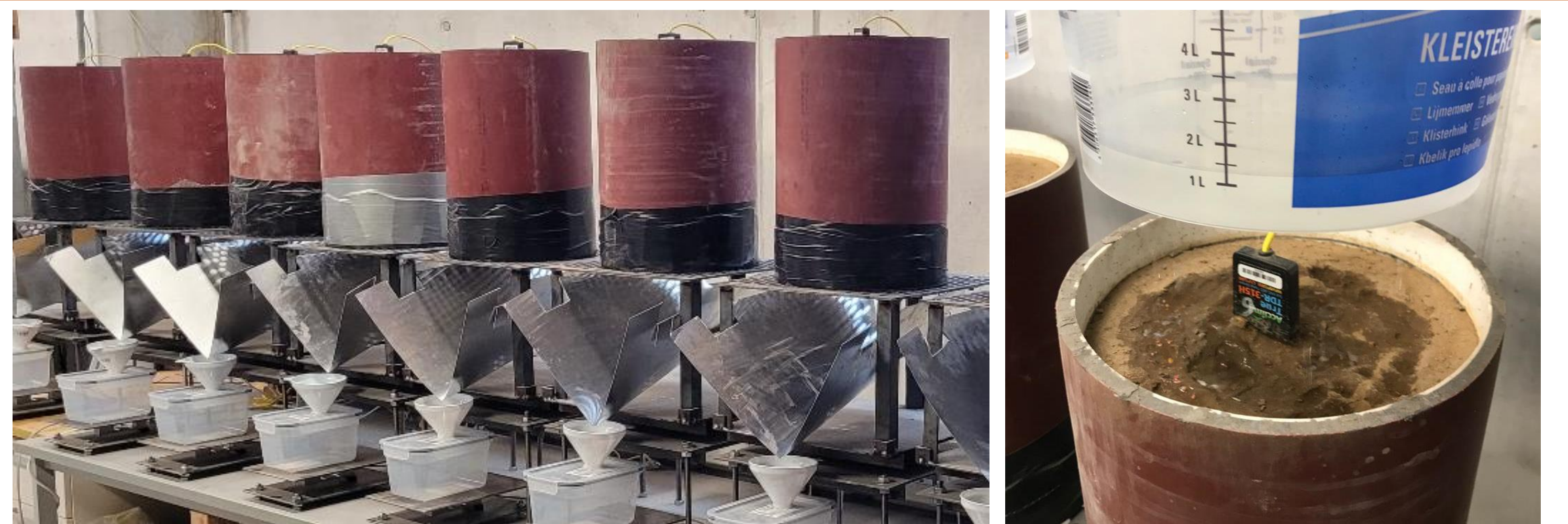
Abb. 2: Kleinlysimeteranlage (links) und Durchführung einer Niederschlagssimulation (rechts)
