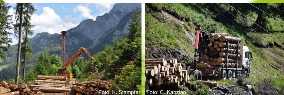
Abbildung 2. Rückung und Aufarbeitung mit Seilgerät und Prozessor haben ein Treibhauspotenzial von circa 4 kg CO<sub>2</sub> equ pro m<sup>3</sup>. Der Holztransport mit LKW hat sich als der größte Emittent von Treibhausgasen innerhalb der Bereitstellungskette erwiesen.
